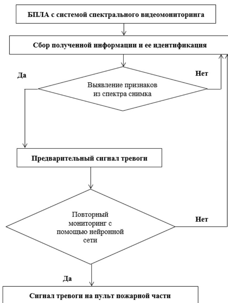
Рисунок 2 – Алгоритм обнаружения пожаров средствами БПЛА
